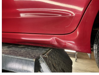
Marşbiyel, sol, Marşbiyel, sol > Hasarlı
