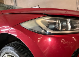
Farlar, Far camı, sağ > Deforme Olmuş
