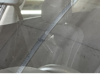
Camlar, Ön cam > Çatlak
