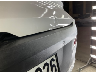
Bagaj kapağı/kapısı, Bagaj kapısı > Ezik
