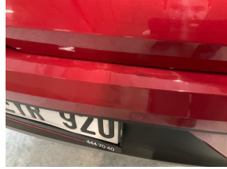
Tampon, arka, Arka tampon > Çatlak
