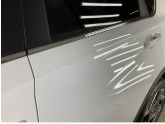
Kapı, sol arka, Kapı, sol arka > Çizik
