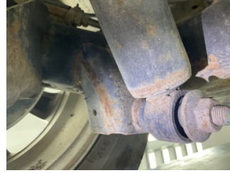
Arka aks, Amortisör, arka sol > Aşınmış
