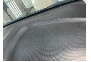
Döşemeler/Kapaklar, Döşemeler/Kapaklar > Çizik
