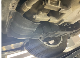
Motor, Alt muhafaza > Hasarlı
