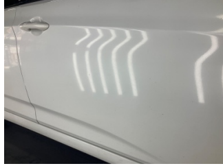
Kapı, sağ ön, Kapı, sağ > Noktasal Ezik
