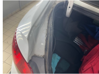
Arka bölüm, Bagaj kapağı fitili > Hasarlı
