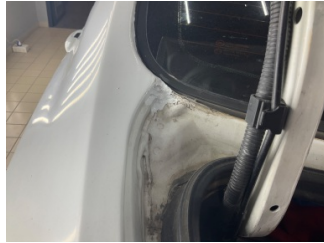
Bagaj kapağı/kapısı, Bagaj kapısı > Standart Dışı Onarım
