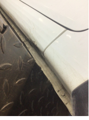
Marşbiyel, sağ, Marşbiyel, sağ > Hasarlı
