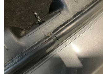
Arka bölüm, Bagaj kapağı fitili > Hasarlı
