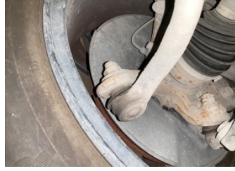
Direksiyon sistemi, Rot kolu/Rot başı, sol > Hasarlı
