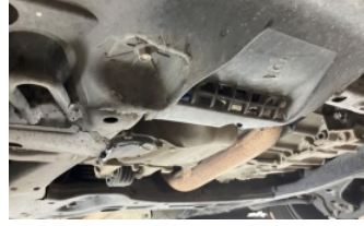
Tampon, ön, Tampon koruyucu orta > Hasarlı
