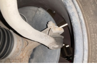
Direksiyon sistemi, Rot kolu/Rot başı, sağ > Hasarlı
