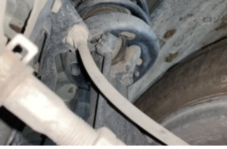
Ön aks, Denge çubuğu, bağlantı çubuğu sağ > Hasarlı
