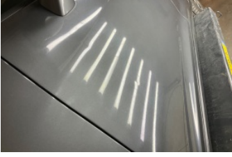
Kapı, sol ön, Kapı, sol ön > Ezik
