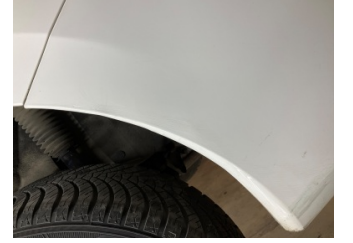
Tampon, arka, Arka tampon > Çatlak
