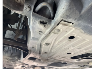
Motor, Alt muhafaza > Hasarlı
