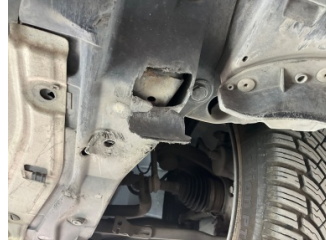
Motor, Alt muhafaza > Hasarlı
