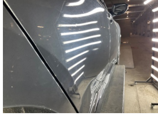
Kapı, sağ arka, Kapı, sağ arka > Noktasal Ezik
