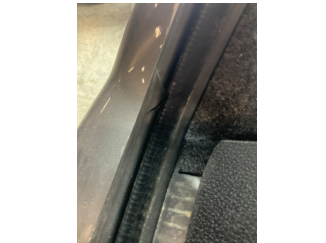
Arka bölüm, Bagaj kapağı fitili > Hasarlı
