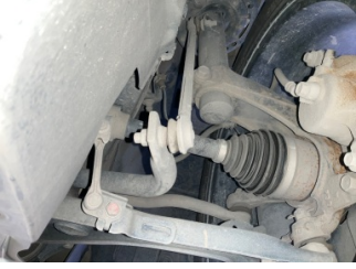
Ön aks, Denge çubuğu, bağlantı cubuğu sol > Deforme Olmuş
