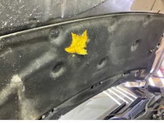
Motor kaputu, izolasyon döşemesi > Hasarlı
