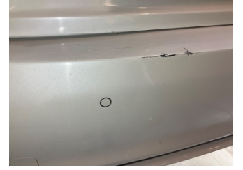
Tampon, arka, Arka tampon > Çatlak
