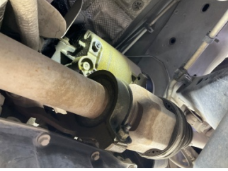
Kalorifer/Klima, Klima kompresörü > Yağ Kaçağı
