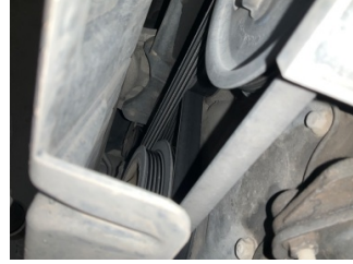
Motorsoğutması, Kayış > Çatlak
