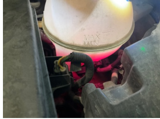
Motorsoğutması, Soğutma sıvısı > Eksik
