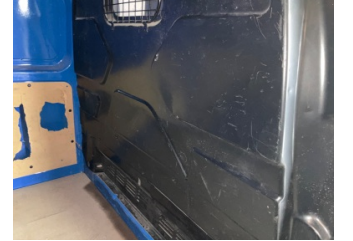
Döşemeler/Kapaklar, Döşemeler/Kapaklar > Çizik
