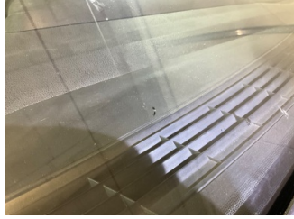
Camlar, Ön cam > Çatlak
