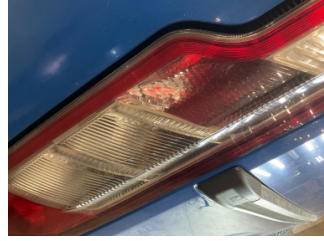
Arka lambalar, Arka lamba camı, sağ > Çatlak
