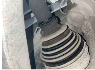
Ön aks, Aks mili, sağ > Yağ Kaçağı
