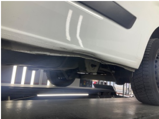
Marşbiyel, sol, Marşbiyel, sol > Hasarlı
