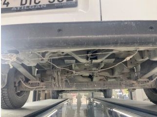
Elektrik donanımı/Pano, Kablo demeti > Sabitlemesi Hatalı
