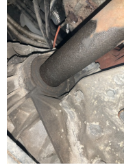
Ön aks, Aks mili, sağ > Yağ Kaçağı
