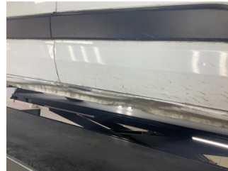
Marşbiyel, sağ, Marşbiyel, sağ > Hasarlı
