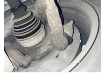
Ön aks, Denge çubuğu, bağlantı cubuğu sağ > Hasarlı
