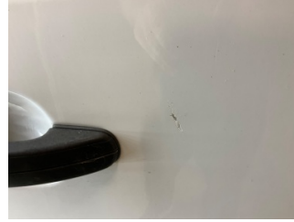
Bagaj kapağı/kapısı, Bagaj kapısı, sağ > Çizik
