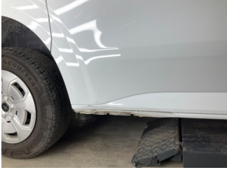
Kapı, sağ arka, Kapı, sağ arka > Ezik
