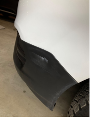
Tampon, ön, Spoiler > Sabitlemesi Hatalı
