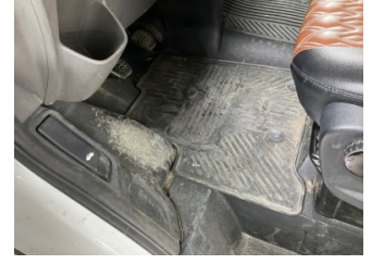
Taban, Taban halısı > Hasarlı
