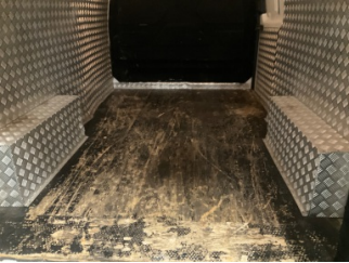
Döşemeler/Kapaklar, Bagaj bölümü döşemesi > Deforme Olmuş
