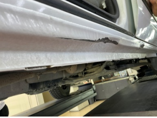
Marşbiyel, sağ, Marşbiyel, sağ > Hasarlı
