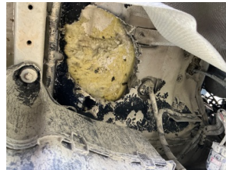
Motor, Motor izolasyonu > Hasarlı
