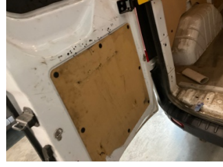
Döşemeler/Kapaklar, Döşemeler/Kapaklar > Deforme Olmuş
