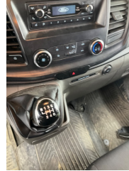
Şanzıman, Vites topuzu > Deforme Olmuş
