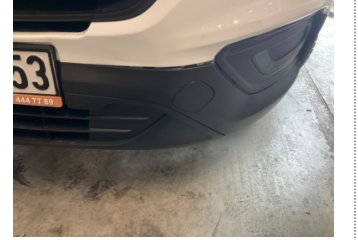
Tampon, ön, Ön tampon > Sabitlemesi Hatalı
