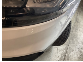
Tampon, ön, Ön tampon > Sabitlemesi Hatalı
