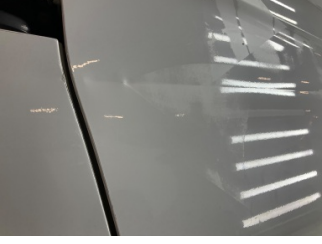
Kapı, sağ arka, Kapı, sağ arka > Ezik
