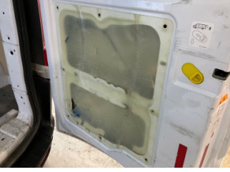
Döşemeler/Kapaklar, Bagaj kapağı, iç döşemesi > Sökülmüş-Yok
