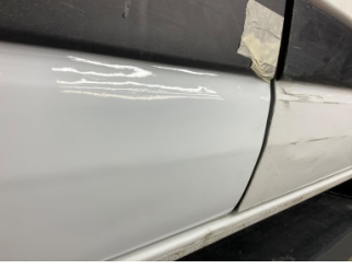
Kapı, sağ arka, Kapı, sağ arka > Ezik
