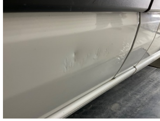
Kapı, sol ön, Kapı, sol ön > Ezik
