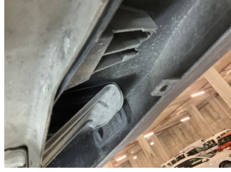
Tampon, arka, Bağlantı ayağı > Hasarlı
