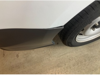
Tampon, arka, Arka tampon > Sabitlemesi Hatalı
