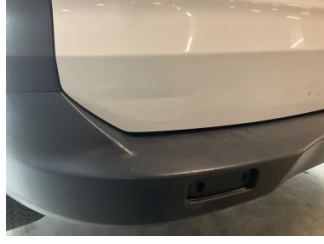
Bagaj kapağı/kapısı, Bagaj kapısı, sol > Ezik
