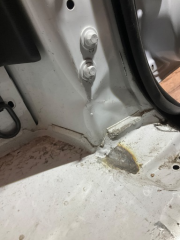
Arka bölüm, Bagaj havuzu > Hasarlı
