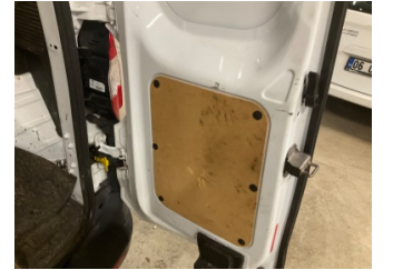
Döşemeler/Kapaklar, Bagaj bölümü döşemesi > Hasarlı
