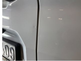
Bagaj kapağı/kapısı, Bagaj kapısı > Noktasal Ezik
