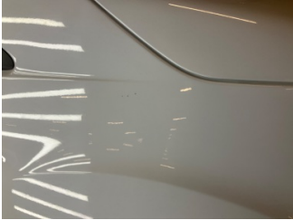
Çamurluk, sağ, Çamurluk, sağ > Taş Izi
