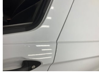
Kaporta, Kaporta > Deforme Olmuş
