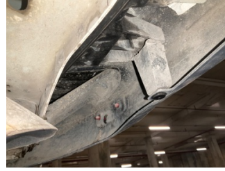
Tampon, arka, Bağlantı ayağı > Hasarlı
