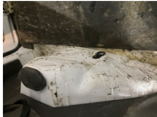
Döşemeler/Kapaklar, Bagaj kapağı, iç döşemesi > Ezik
