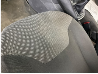
Döşemeler/Kapaklar, Döşemeler/Kapaklar > Yakıcı Madde ile Zarar Görmüş
