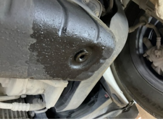
Motor, Yağ karteri > Yağ Kaçağı
