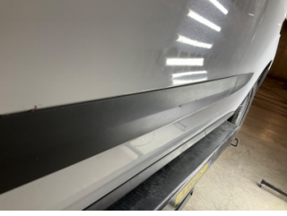
Kapı, sol ön, Kapı bandı > Çizik
