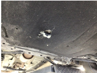
Motor, Alt muhafaza > Hasarlı
