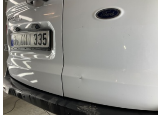
Bagaj kapağı/kapısı, Bagaj kapısı > Ezik
