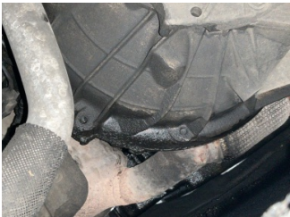
Motor, Motor > Yağ Kaçağı
