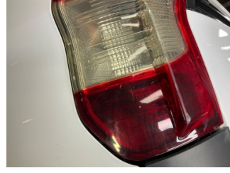
Arka lambalar, Arka lamba camı, sağ > Çatlak
