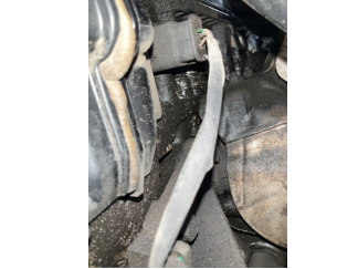
Motor, Motor > Yağ Kaçağı
