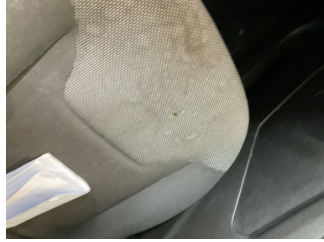
Döşemeler/Kapaklar, Döşemeler/Kapaklar > Yakıcı Madde ile Zarar Görmüş
