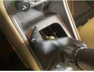
Şanzıman, Vites körüğü > Hasarlı
