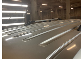
Tavan, Tavan > Dolu Hasarı
