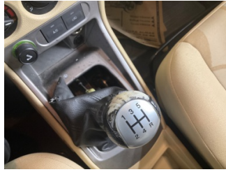
Şanzıman, Vites topuzu > Deforme Olmuş
