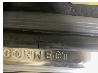
Kapı, sol ön, Kapı fitili > Hasarlı
