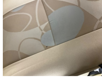
Döşemeler/Kapaklar, Döşemeler/Kapaklar > Yakıcı Madde Ile Zarar Görmüş
