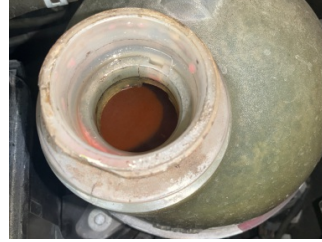
Motorsoğutması, Soğutma sıvısı > Kirlenmiş
