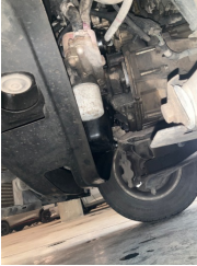
Motor, Motor > Yağ Kaçağı
