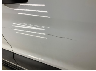
Kapı, sağ ön, Kapı, sağ ön > Yüzeysel çizik
