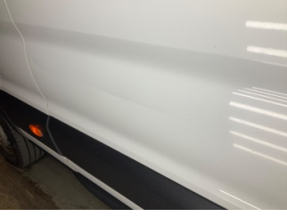
Kapı, sağ arka, Kapı, sağ arka > Ezik
