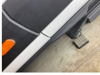
Kapı, sağ arka, Kapı, sağ arka > Ezik
