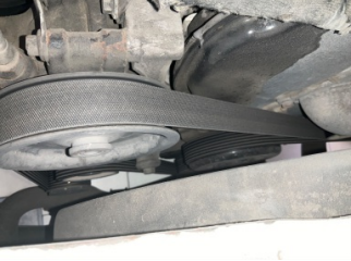
Motorsoğutması, Kayış > Deforme Olmuş
