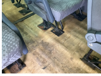
Taban, Taban halısı > Hasarlı
