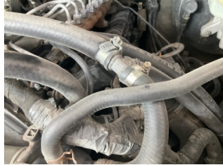
Motorsoğutması, Hortumlar > Standart Dışı Onarım
