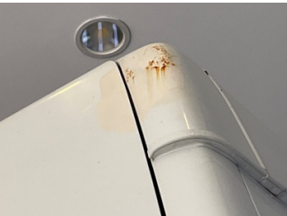
Kaporta, D-direk, sağ > Hasarlı
