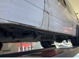
Marşbiyel, sol, Marşbiyel, sol > Hasarlı
