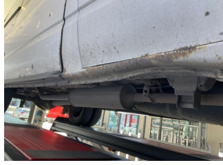
Marşbiyel, sağ, Marşbiyel, sağ > Hasarlı
