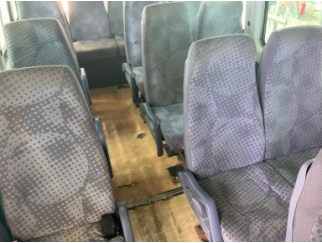
Döşemeler/Kapaklar, Döşemeler/Kapaklar > Deforme Olmuş
