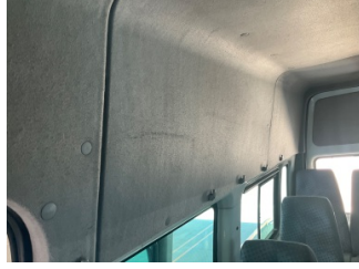
Döşemeler/Kapaklar, Tavan döşemesi > Deforme Olmuş
