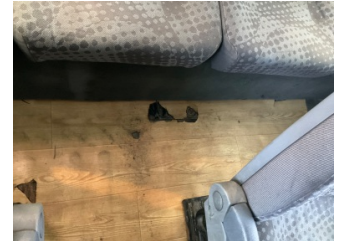
Taban, Taban halısı > Hasarlı
