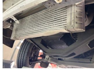
Motorsoğutması, Radyatör > Hasarlı
