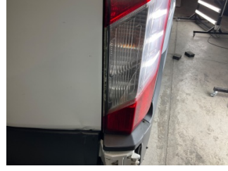
Arka lambalar, Arka lamba camı, sağ > Çatlak
