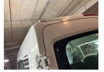
Kaporta, Sol Üst Frangart > Hasarlı
