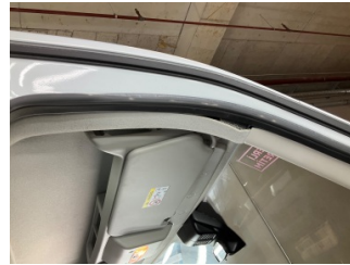
Döşemeler/Kapaklar, Tavan döşemesi > Sabitlemesi Hatalı
