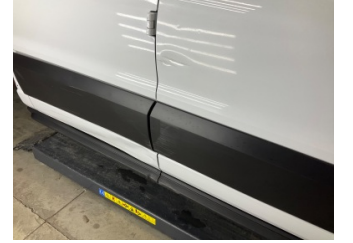
Kapı, sağ ön, Kapı bandı > Çizik
