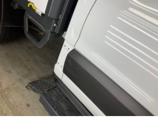
Kapı, sağ arka, Kapı bandı > Eksik
