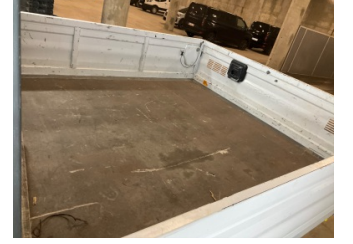
Döşemeler/Kapaklar, Bagaj kapağı, iç döşemesi > Boyası Atmış
