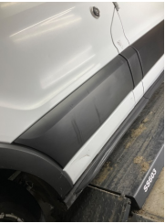
Kapı, sol ön, Kapı, sol ön > Ezik
