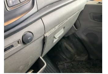
Döşemeler/Kapaklar, Döşemeler/Kapaklar > Hasarlı
