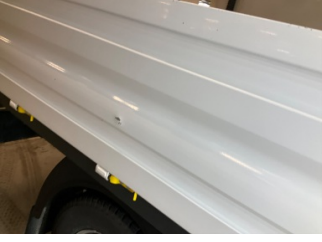
Çamurluk, sağ arka, Çamurluk, sağ arka > Ezik
