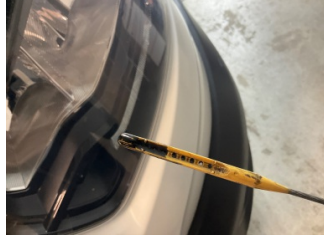
Motor, Yağ seviyesi > Eksik
