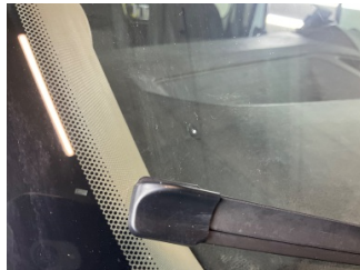
Camlar, Ön cam > Çatlak
