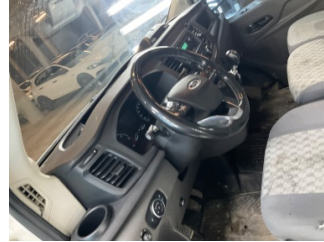
Direksiyon sistemi, Direksiyon simidi > Deforme Olmuş
