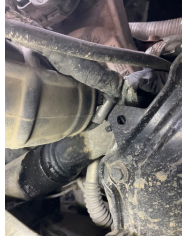
Motor, Turbo hortumları > Yağ Kaçağı
