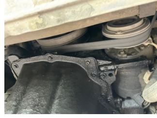
Motorsoğutması, Kayış > Deforme Olmuş
