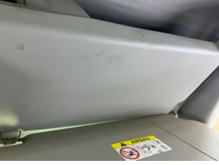
Döşemeler/Kapaklar, Döşemeler/Kapaklar > Yakıcı Madde ile Zarar Görmüş
