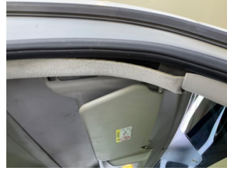
Döşemeler/Kapaklar, Tavan döşemesi > Sabitlemesi Hatalı
