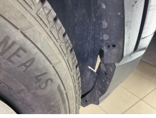
Çamurluk, sağ, Davlumbaz > Sabitlemesi Hatalı
