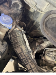
Motor, Hava filtresi kabı > Sabitlemesi Hatalı
