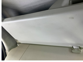
Döşemeler/Kapaklar, Döşemeler/Kapaklar > Yakıcı Madde ile Zarar Görmüş
