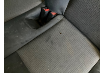
Döşemeler/Kapaklar, Döşemeler/Kapaklar > Yakıcı Madde ile Zarar Görmüş
