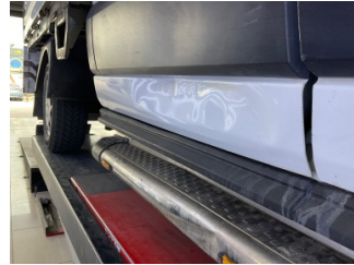
Kapı, sağ arka, Kapı, sağ arka > Hasarlı
