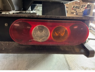
Arka lambalar, Arka lamba camı, sağ > Kırılmış
