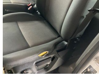
Koltuklar, ön, Koltuk döşemesi, sol ön > Hasarlı
