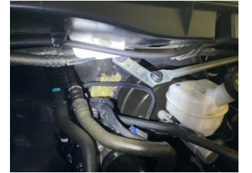
Motor, Motor izolasyonu > Hasarlı
