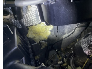
Motor, Motor izolasyonu > Hasarlı
