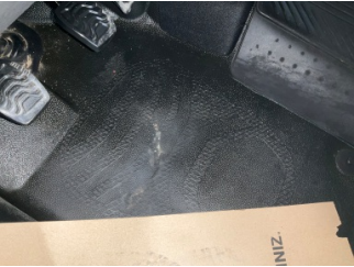
Döşemeler/Kapaklar, Döşemeler/Kapaklar > Deforme Olmuş
