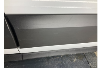
Kapı, sol arka, Kapı bandı > Çizik
