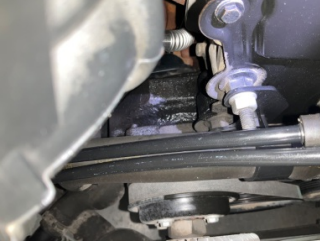
Motor, Motor > Yağ Kaçağı
