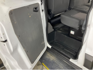
Döşemeler/Kapaklar, Döşemeler/Kapaklar > Deforme Olmuş
