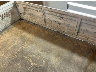
Döşemeler/Kapaklar, Bagaj kapağı, iç döşemesi > Boyası Atmış
