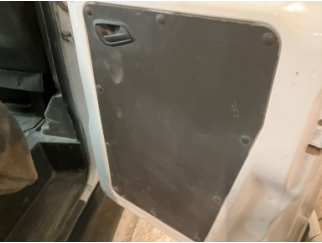
Döşemeler/Kapaklar, Döşemeler/Kapaklar > Deforme Olmuş
