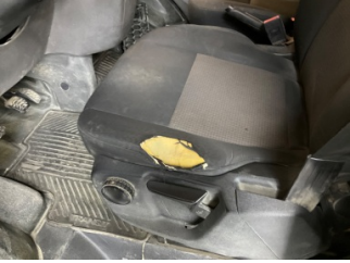
Döşemeler/Kapaklar, Döşemeler/Kapaklar > Hasarlı
