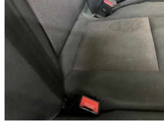
Döşemeler/Kapaklar, Döşemeler/Kapaklar > Yakıcı Madde ile Zarar Görmüş
