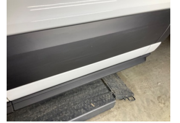
Kapı, sol arka, Kapı bandı > Çizik
