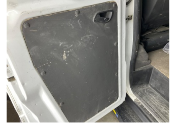
Döşemeler/Kapaklar, Döşemeler/Kapaklar > Deforme Olmuş
