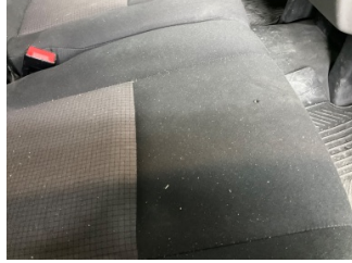
Döşemeler/Kapaklar, Döşemeler/Kapaklar > Yakıcı Madde ile Zarar Görmüş
